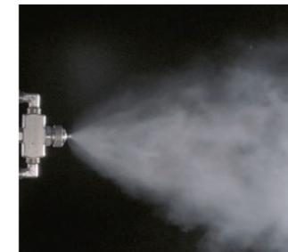
■ Atomisation de fumée liquide par air comprimé
