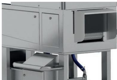
■ Bande transporteuse démontable (polyéthylène)
