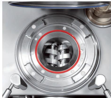
■ Double vis en place (trémie relevée)
