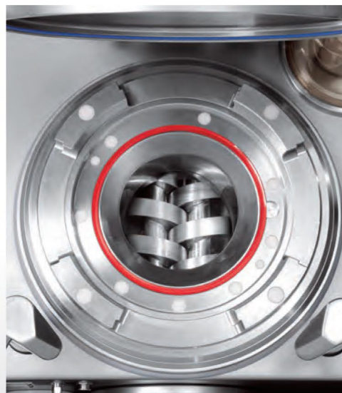
■ Double vis en place (trémie relevée)
